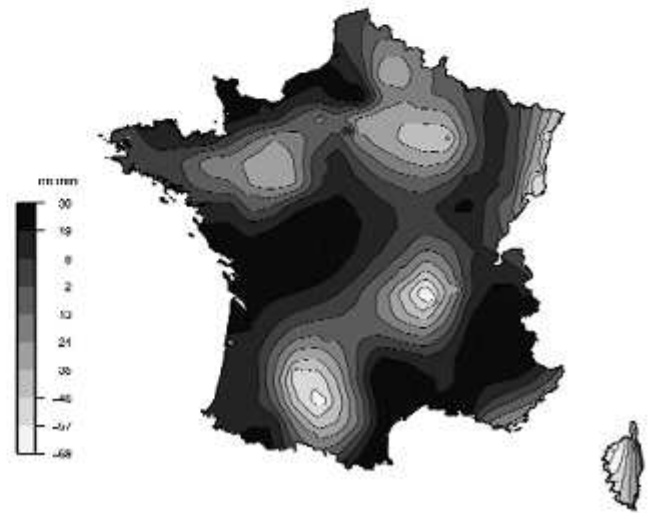
État des réserves au 20 décembre 2011 (écart en mm par rapport à la normale pour une réserve utile de 150 mm)
